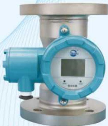
NMX系列金属管转子流量计常用于测量液体、气体和蒸汽流量，针对腐蚀性介质还可以提供内衬PTFE材质或其它特殊材质。仪表基本高度为250mm，便于配管设计，互换性强。除就地指示外，还具有开关信号输出，4~20mA DC电流输出、HART通讯协议功能及LCD（带背光）显示累积流量等。由于结构简单、维护方便、工作可靠、压力损失小、对直管段基本无要求等优点，被广泛应用于石油、化工、冶金、纺织印染、环保、制药、食品、电力等工业领域。
