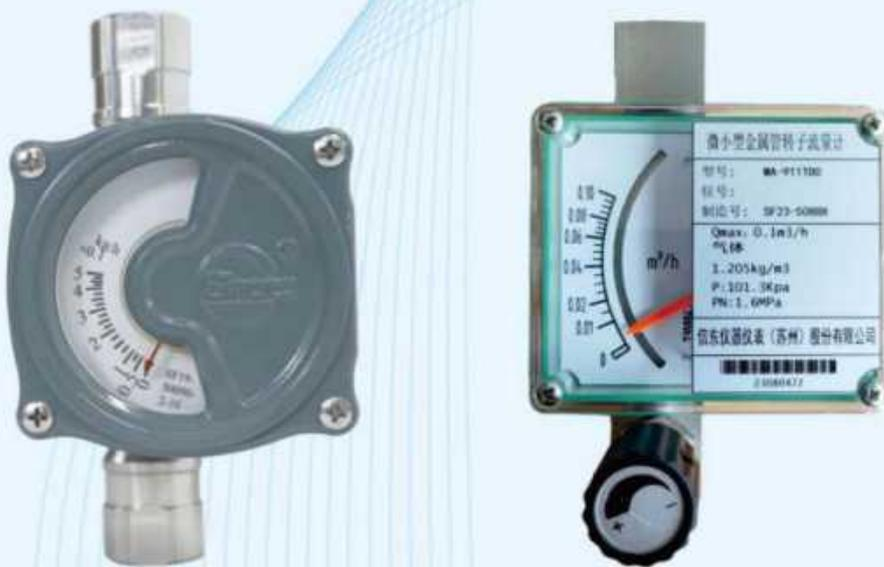
MA-900系列金属管转子流量计，适用于测量小流量的液体和气体。测量介质的某一流量，对应磁性浮子在测量管中的一个浮子位置，这个浮子位置通过指示器中的磁钢耦合给指针，由刻度盘和指针读出相应的流量值。
